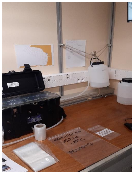
Figure 20 : Installations permettant la filtration de l'eau et la récupération d'ADNe – photo C. Vansteenbergh
